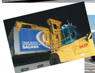
コンテナの積み降ろしをする トップリフター
