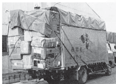
1個でも多くの荷物を積むために後部荷台の仕切り板を倒してその上に荷物を積み、幌をかけなおします。これを「バツタを切る」といい、高度経済成長時の物量の多さが伺えます。
